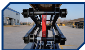
安全检修支架
